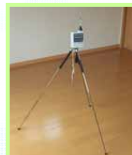
検知管法 ホルムアルデヒド のみ測定可能
