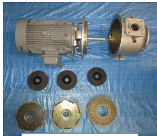
ポンプ分解整備
