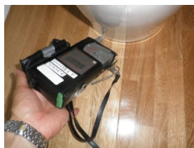
隙間からの臭気測定
